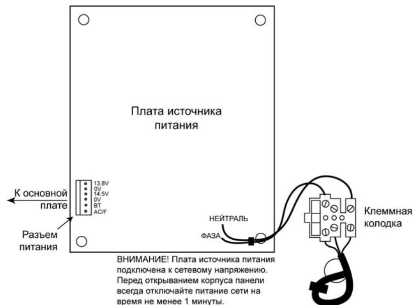
Рис. 2. Плата источника питания
